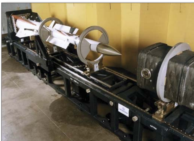
Ракеџа Aster 15 испред конџејнера силоса SYLVER
