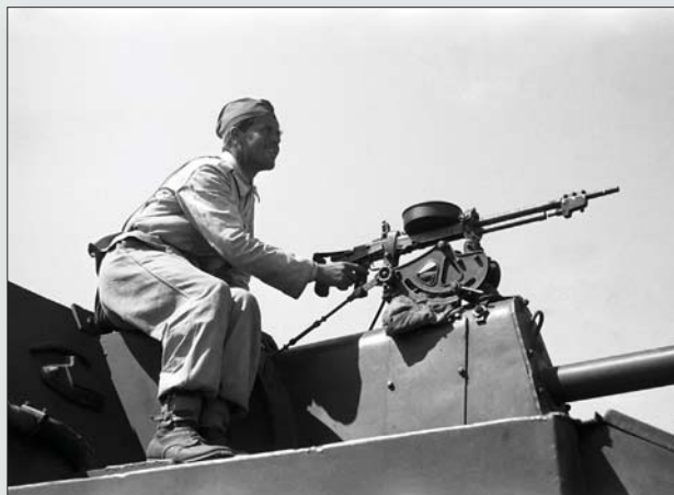
Митраљез „дегџјарев“, постављен на провизорни носач на топу, израђен у радионици у Младеновцу. Уобичајено место за митраљез било је унутар борбеног одељења оруђа.
